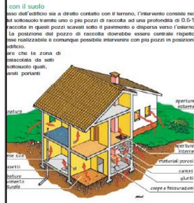
Fig. 3 - Punti d'infiltrazione del radon nell'edificio
